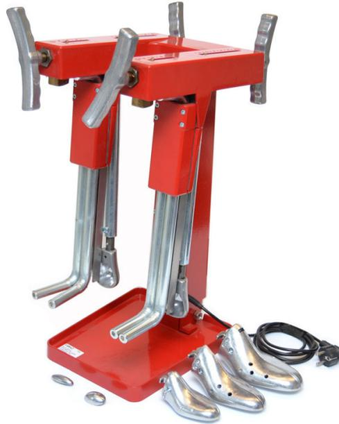
Macchina allargascarpe elettrica professionale, completa di 3 paia di forme: per uomo, donna e bambino. Garantisce l'allargatura in punti specifici della scarpa come la fiocca, la pianta e la punta. Questa macchina è adatta all'uso intensivo.
