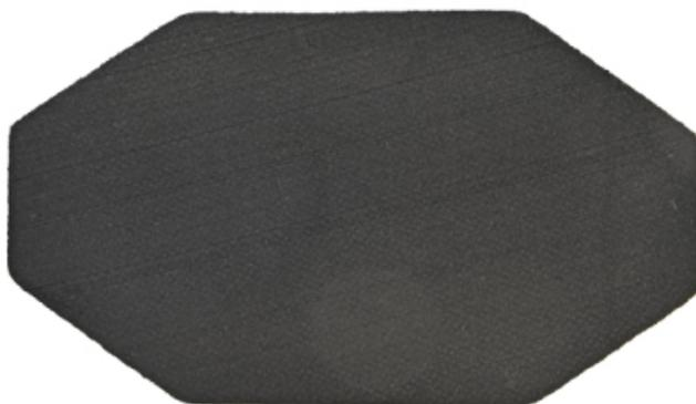
Lastra da costruzione per intersuole. Buona azione shock absorber e buon livello di elasticità, che, associate a una buona leggerezza, ne consigliano l'uso nella produzione di scarpe comfort e sportive. Dotata di una buona termoformabilità (5 minuti a 160°C) può essere facilmente incollata con i normali adesivi neoprenici.
