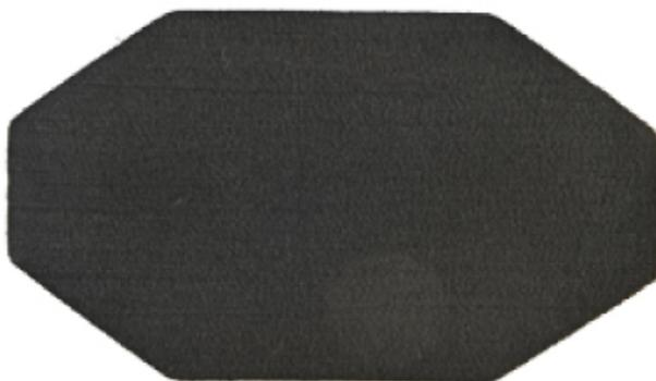
Lastra da costruzione per intersuole. Data la sua elevata azione shock absorber (45 Shore A) associata all'estrema leggerezza è consigliata per le applicazioni ortopediche. Perfetta per la realizzazione di inserti dove si richiede un elevato potere shock absorbing. Dotata di una buona termoformabilità (10 minuti a 120°C) può facilmente essere incollata con i normali adesivi neoprenici.
